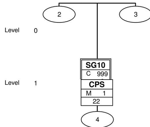
Dies ist ein Branching Diagramm. Jede im Guide dokumentierte Segment- und Segmentgruppenvariante erscheinen hier genau einmal. Mit den Buchstaben M und R bzw. O wird der Anwendungsstatus Muss bzw. Kann gekennzeichnet. D steht für abhängig von (erläutert im Kommentar). Die Zahl rechts davon gibt die maximal zulässige Häufigkeit an. Die untere Zahl gibt die laufende Segmentnummer aus dem Guide an, unter welcher das jeweilige Segment beschrieben ist.
