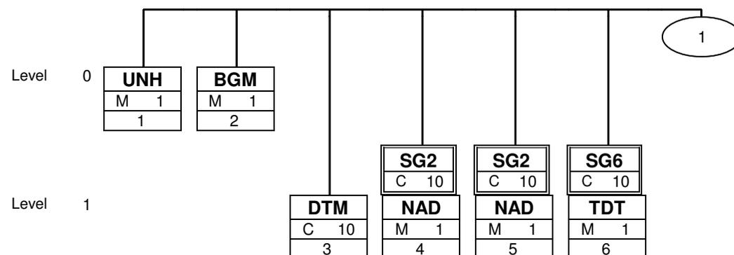
Dies ist ein Branching Diagramm. Jede im Guide dokumentierte Segment- und Segmentgruppenvariante erscheinen hier genau einmal. Mit den Buchstaben M und R bzw. O wird der Anwendungsstatus Muss bzw. Kann gekennzeichnet. D steht für abhängig von (erläutert im Kommentar). Die Zahl rechts davon gibt die maximal zulässige Häufigkeit an. Die untere Zahl gibt die laufende Segmentnummer aus dem Guide an, unter welcher das jeweilige Segment beschrieben ist.
