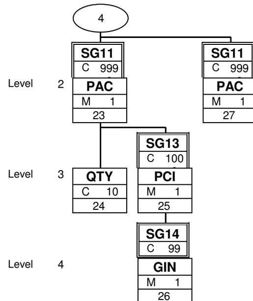
Dies ist ein Branching Diagramm. Jede im Guide dokumentierte Segment- und Segmentgruppenvariante erscheinen hier genau einmal. Mit den Buchstaben M und R bzw. O wird der Anwendungsstatus Muss bzw. Kann gekennzeichnet. D steht für abhängig von (erläutert im Kommentar). Die Zahl rechts davon gibt die maximal zulässige Häufigkeit an. Die untere Zahl gibt die laufende Segmentnummer aus dem Guide an, unter welcher das jeweilige Segment beschrieben ist.
