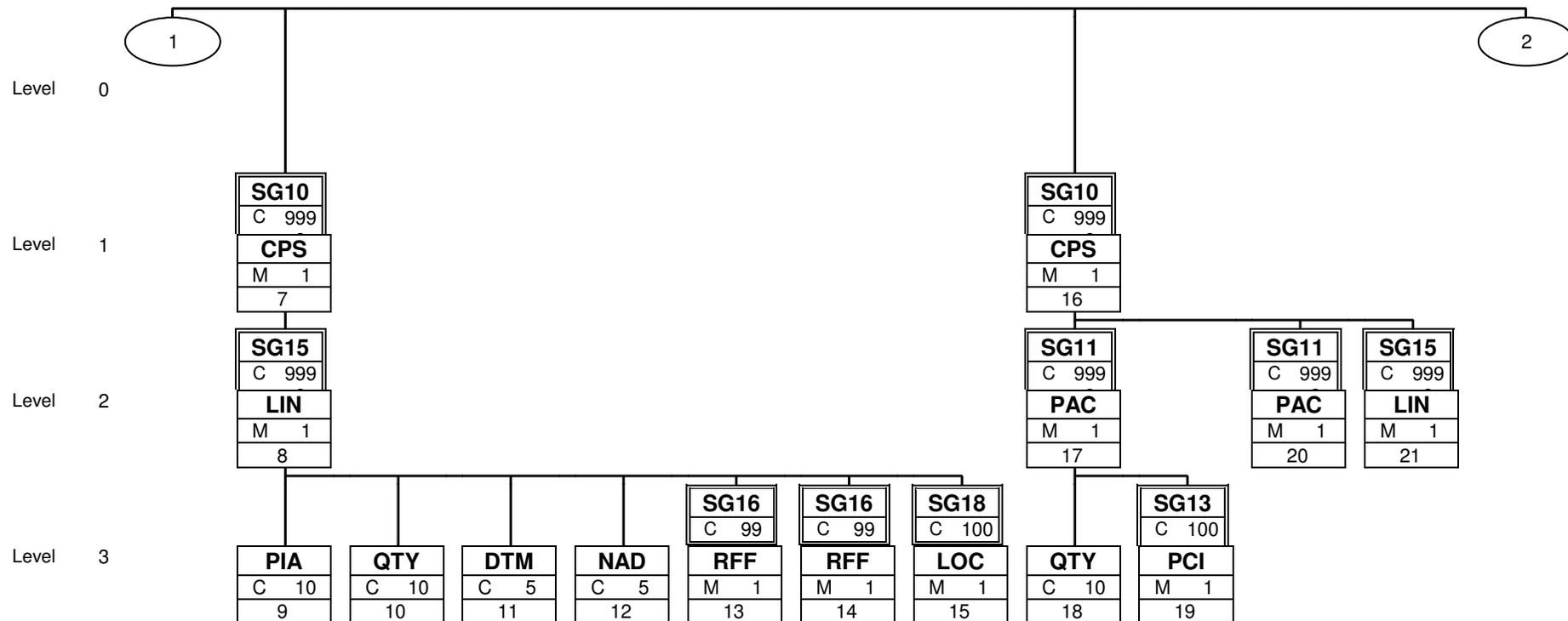
Dies ist ein Branching Diagramm. Jede im Guide dokumentierte Segment- und Segmentgruppenvariante erscheinen hier genau einmal. Mit den Buchstaben M und R bzw. O wird der Anwendungsstatus Muss bzw. Kann gekennzeichnet. D steht für abhängig von (erläutert im Kommentar). Die Zahl rechts davon gibt die maximal zulässige Häufigkeit an. Die untere Zahl gibt die laufende Segmentnummer aus dem Guide an, unter welcher das jeweilige Segment beschrieben ist.
