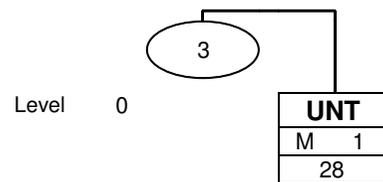
Dies ist ein Branching Diagramm. Jede im Guide dokumentierte Segment- und Segmentgruppenvariante erscheinen hier genau einmal. Mit den Buchstaben M und R bzw. O wird der Anwendungsstatus Muss bzw. Kann gekennzeichnet. D steht für abhängig von (erläutert im Kommentar). Die Zahl rechts davon gibt die maximal zulässige Häufigkeit an. Die untere Zahl gibt die laufende Segmentnummer aus dem Guide an, unter welcher das jeweilige Segment beschrieben ist.
